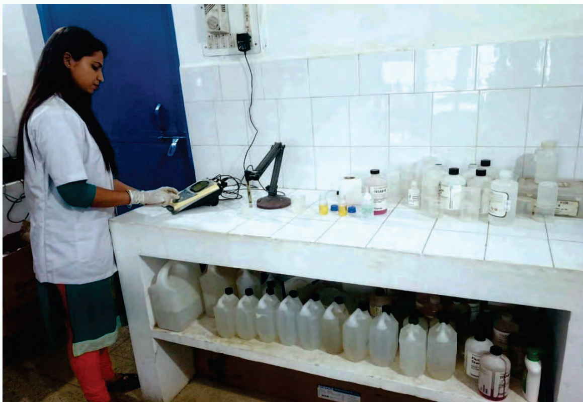
भारत सरकार के जल गुणवत्ता अनुश्रवण एवं निगरानी कार्यक्रम के अंतर्गत जिला स्तरीय प्रयोगशाला में आयन मीटर द्वारा फ्लोराइड एवं नाइट्रेट का पेयजल परीक्षण कार्य – जिला प्रयोगशाला शाजापुर
